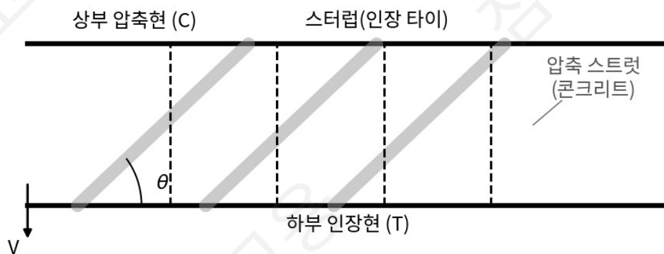
그림 3-1. 변각 트러스 모델: 압축 스트럿( \theta ), 인장 타이, 상·하부 현
